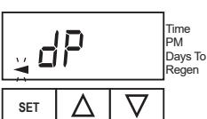
Если установлен датчик перепада давления, то существует два варианта начала регенерации:
