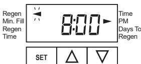
Если количество дней до начала регенерации равно одному, то регенерация начнется по достижении установленного времени регенерации.
