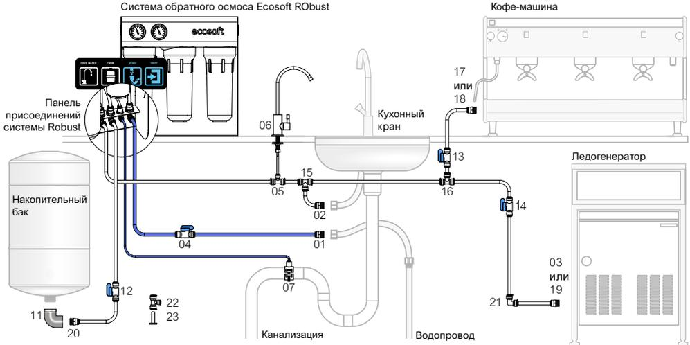
Часть фитингов на схеме поставляются в комплекте к системе ROust. Фитинги из комплекта дополнительных присоединений могут использоваться вместо оригинальных либо вместе с ними, если необходимо подключить накопительный бак с присоединением  $\frac{3}{4}$ " дюйма или более одного устройства-потребителя очищенной воды с присоединениями  $\frac{3}{8}$ " или  $\frac{1}{2}$ ".
